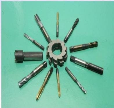
\* - осевой инструмент (метчики, сверла, зенкера, развертки, фрезы, в т.ч. ступенчатый и комбинированный инструмент) из быстрорежущих и твердосплавных материалов;
