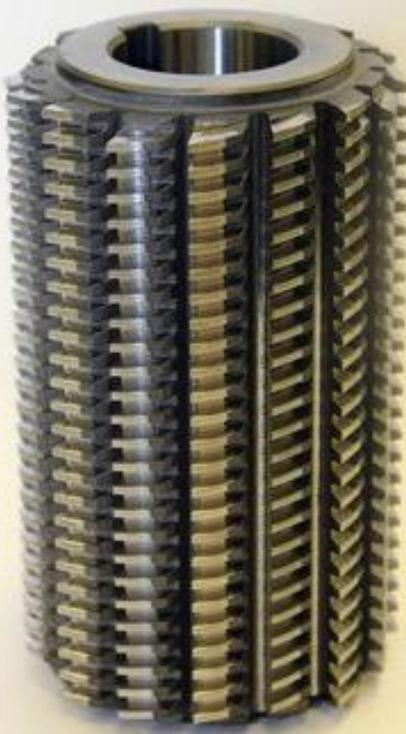
Для нарезания цилиндрических зубчатых колес с эвольвентным профилем - червячные фрезы одно- и многозаходные, право- и леворежущие;
