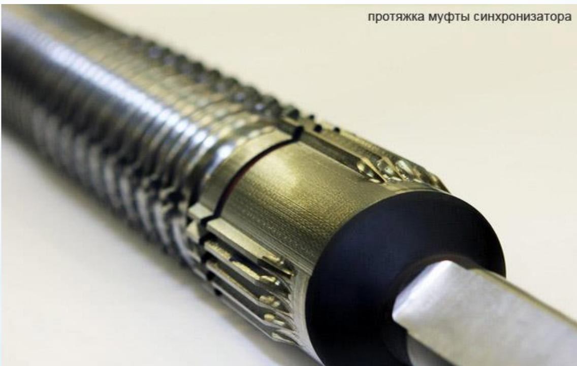
протяжка муфты синхронизатора
