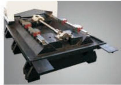
Большой пролет, основание с роликовой линейной направляющей
