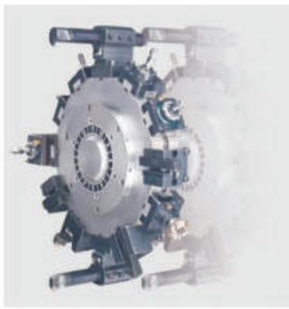
12 местная револьверная головка с приводным инструментом
